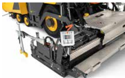
Nivellierausrüstung – kompatibel mit gängigen 3D Systemen
