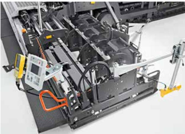
Absauganlage für Bitumendämpfe
