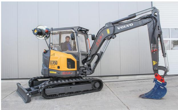
Volvo Kompaktbagger ECR50 mit Elektroantrieb inkl. Kabeltrommel sowie zusätzlicher Funkfernsteuerung mit Kameraüberwachungssystem, für einen Untertage-Bergwerkseinsatz
